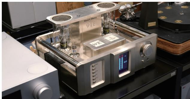
筆者在去年視聽展期間，初步接觸「西電」（Western Electric）以嶄新線路設計合併機WE91E的實體樣板機，並聞說這機是廠方用上五年時間研製，以一對300B膽管能夠做到每聲道高達20瓦的高功率單端輸出，不由得產生莫大的好奇心，究竟以往聽過音色甜美怡人的每聲道只有8瓦的傳統300B機種，今天究竟蛻變成怎麼樣的光景。到了今年五月上旬，WE91E的正式產品終於送抵本刊試音室，經過差不多大半個月的煲煉，配上靈敏度達93dB的天朗Turnberry揚聲器，可以正式試聽了。
